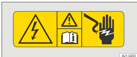
Bild 5 Varningsskylt i motorrummet.
