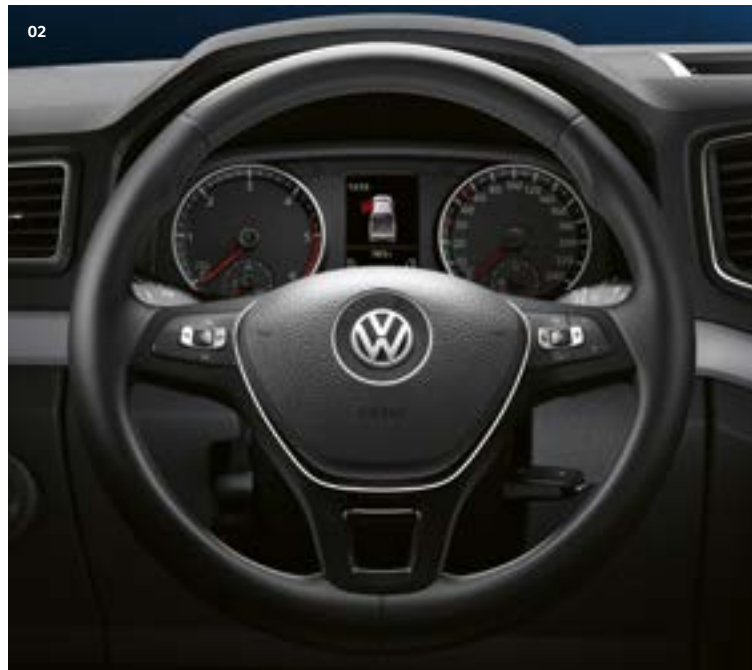
02 Läderklädd multifunktionsratt med paddlar. Ratten är greppvänlig och navigationssystem och mobiltelefon kan hanteras via knappar på ratten. Därigenom blir körningen säkrare då händerna kan hållas på ratten hela tiden. Paddlarna kan användas för att byta växel. | CL | HL | AV |
