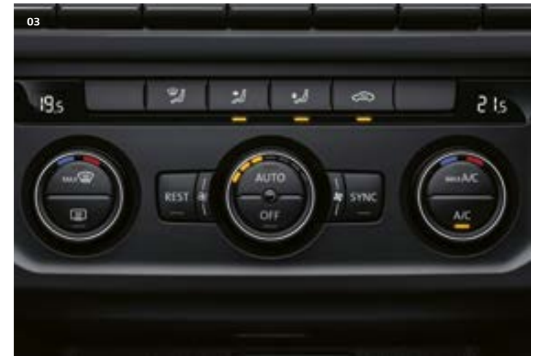
03 "Climatronic" luftkonditionering. Systemet har 2-zoners temperaturkontroll för föraren och framsätesspassageraren, manuell återcirkulation av luften och en sensor för luftkvaliteten. Systemet tillför kall luft beroende på beroende på solstrålningens intensitet och utomhustemperaturen. | CL | HL | AV |
