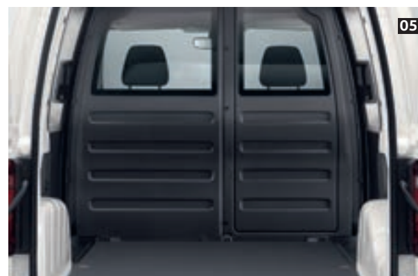
04 Hel mellanvägg. 1) Stabil avskiljare mellan förarutrymmet och lasten. Mellanväggen når upp till standarden DIN 75410-3.
