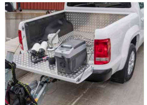
FLAKET ÄR INKLÄTT med durk-aluminium för att vara slitstarkt och lätt att rengöra. Dessutom rätt snyggt.
