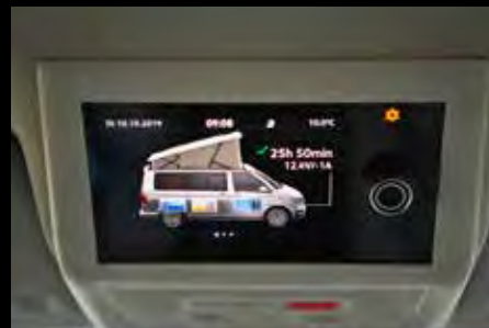
OVANFÖR BACKSPEGELN sitter campingdisplaysen med information om nästan allt, bland annat hur länge batterierna räcker (25 timmar och 50 minuter).
