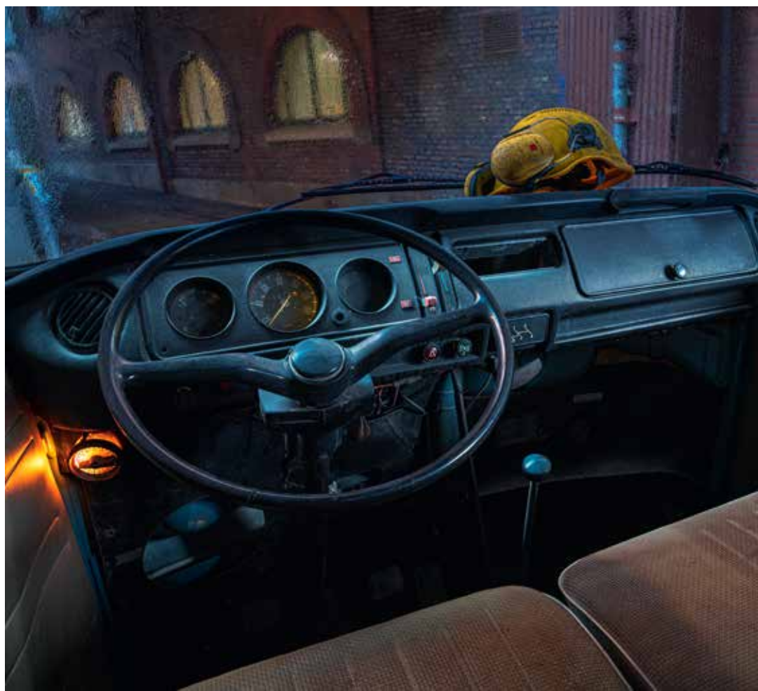
BRA MED UTRYMME, fin sikt och bekväma säten. Folkabussarna och Folkapickuperna var bekväma för sin tid. Notera tiduret till motor- och kupevärmaren till vänster.
