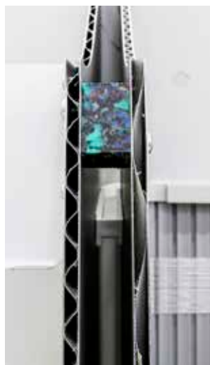
NÄRBILD PÅ DET lätta och starka aluminium-materialet som förvarings-skåpen och köket är byggda av. Flygplans-tillverkaren Airbus använder samma material till inredningen i sina flygplan.
