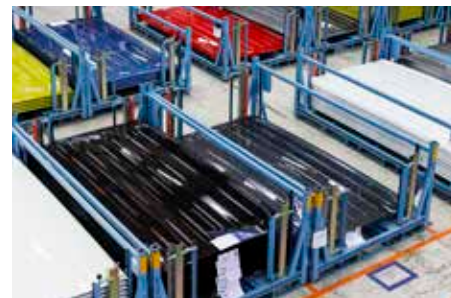
SEXTON OLIKA FÄRGER betyder sexton olika tak. De U-formade aluminiumramarna ovan monteras i framkant på taket och förstärker karossen.
