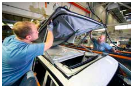
DET FÄLLBARA TAKET monteras stående – en halv trappa upp. Monterat och klart mäter bilen 199 cm på höjden, vilket betyder att parkering i de flesta P-garage är möjligt. En viktigt detalj.
