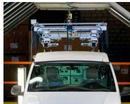
DET TILLFÄLLIGA TRANSPORTTAKET används vid transport av bilarna mellan fabriken och specialanläggningen där California byggs.
