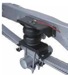
Komplementluftfjädring mellan ram och bakaxel
