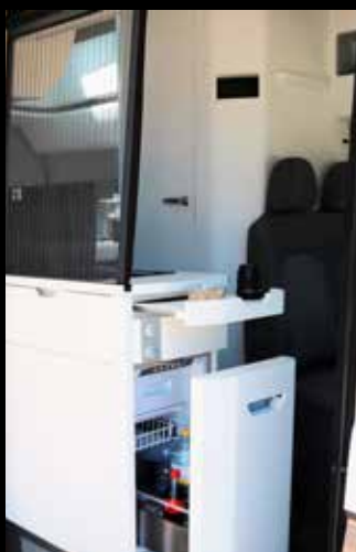
GENOM KYLENS utformning är innehållet åtkomligt både från ut- och insida av bilen.
