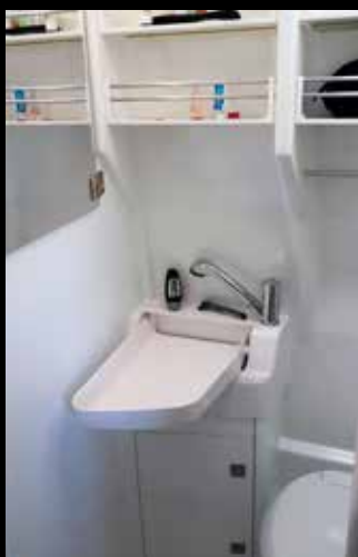
FÖRVARINGSPLATS under och över det fällbara handfatet. Utdragbar kran blir duscharmatur.
