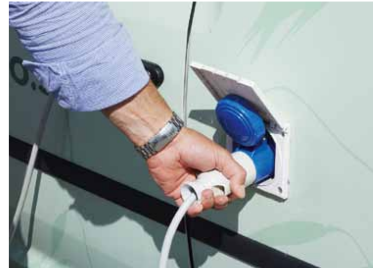
Om bilen behöver parkeras med kylvaror ombord kan kylaggregatet hållas igång med 220 volt från vanligt vägguttag. Innanför de tjocka isolerande dörrarna hänger plastskynken för att minimera kylfläckage. Kylskåpets funktion styrs med en display på instrumentpanelen.
