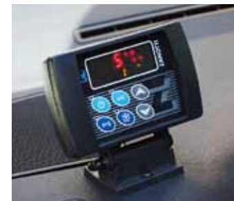
Om bilen behöver parkeras med kylvaror ombord kan kylaggregatet hållas igång med 220 volt från vanligt vägguttag. Innanför de tjocka isolerande dörrarna hänger plastskynken för att minimera kylfläckage. Kylskåpets funktion styrs med en display på instrumentpanelen.
