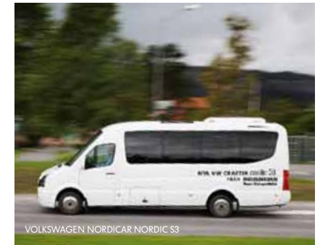
Bakom ratten på Nordic S3 trivs Peter Ekholm. Modellen är byggd på ett ramchassi med glasfiberkaross, vilket ger förutom lägre tjänstevikt även snyggare proportioner. Panoramafönster i isolerglas.
