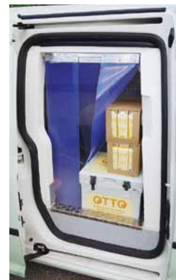
Om bilen behöver parkeras med kylvaror ombord kan kylaggregatet hållas igång med 220 volt från vanligt vägguttag. Innanför de tjocka isolerande dörrarna hänger plastskynken för att minimera kylfläckage. Kylskåpets funktion styrs med en display på instrumentpanelen.
