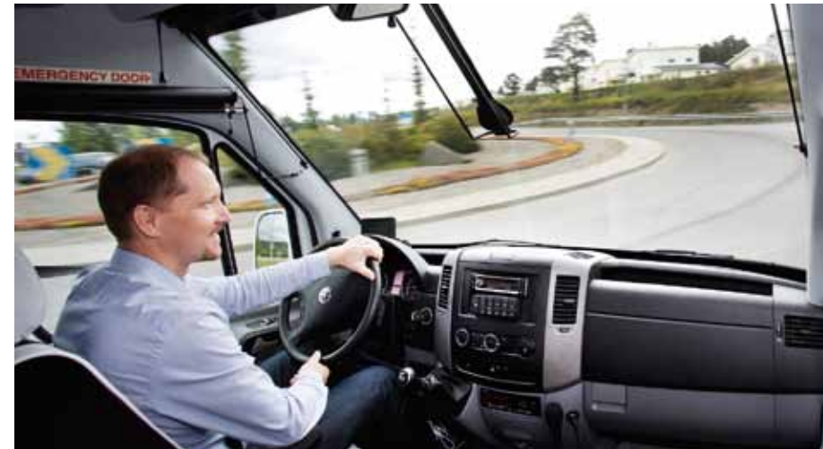
Bakom ratten på Nordic S3 trivs Peter Ekholm. Modellen är byggd på ett ramchassi med glasfiberkaross, vilket ger förutom lägre tjänstevikt även snyggare proportioner. Panoramafönster i isolerglas.
