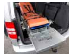
VW Caddy Maxi Life. Utrustad med bårsläde som med några enkla handgrepp ersätter baksätet. För liggande sjuktransport. Inget ingrepp i bilen, sätts fast i befintliga infästningar för bakersta sätet.
