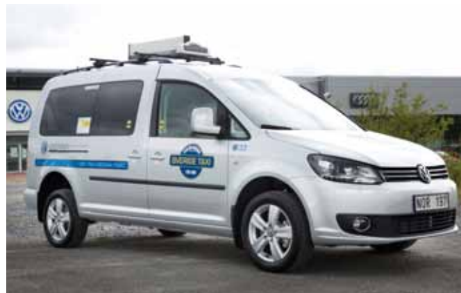
VW Caddy Maxi Life. Utrustad med bårsläde som med några enkla handgrepp ersätter baksätet. För liggande sjuktransport. Inget ingrepp i bilen, sätts fast i befintliga infästningar för bakersta sätet.
