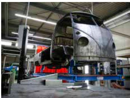
EN PLÅTREN KAROSS i väntan på ny lack. Varenda millimeter av bilen ses över i jakten på rost.
