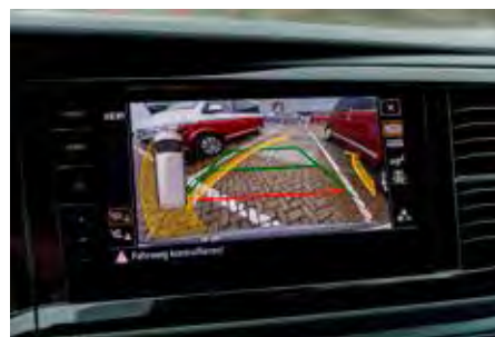
PARK ASSIST hjälper dig att fickparkera både i längsled och parallellt. Övan syns instrumenteringen med stor karta.
