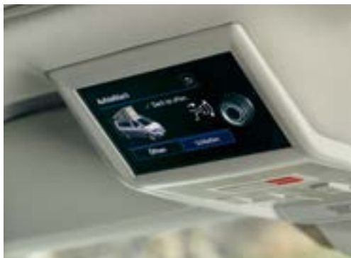
Styrning av det elektrohydrauliskt öppningsbara taket. 1)
