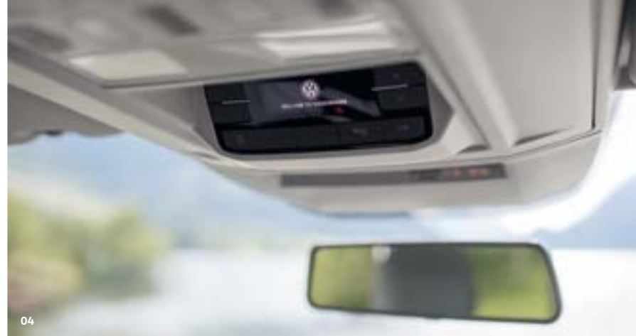
04 Kontrollpanel för extravärmaren (tillval). Enheten är lätt åtkomlig i takpanelen. Pekskrmen gör det enkelt att styra och programmera extravärmaren.
